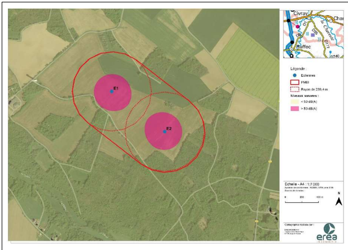
Illustration des niveaux sonores en rapport avec le Périmètre de Mesure du Bruit de l'Installation
